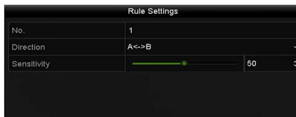
Figura 10–5 Establecer las reglas de detección de cruce de línea
