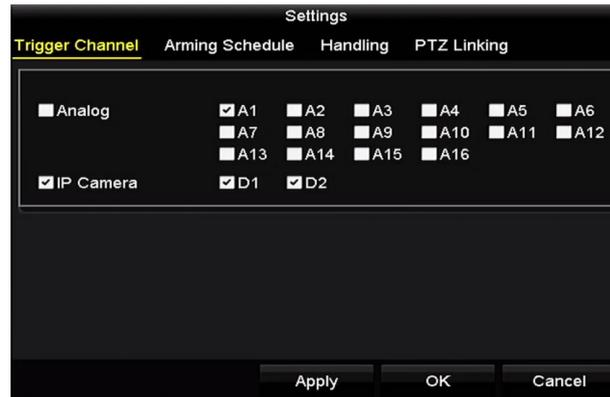
Figura 9–15 Establecer activación de cámaras de POS
