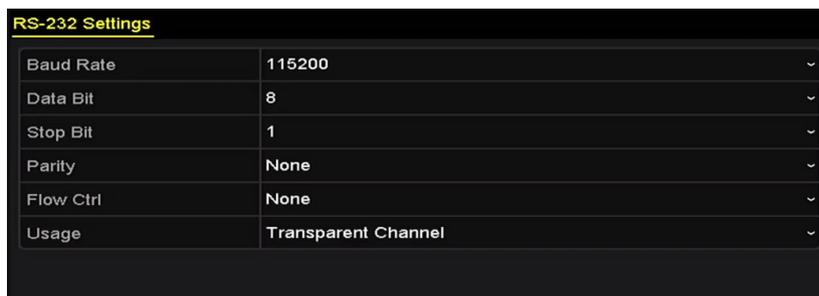
Figura 9–9 Configuración de la conexión RS-232
