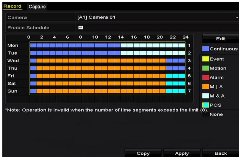
Figura 5–12 Trazado de la programación de grabación
