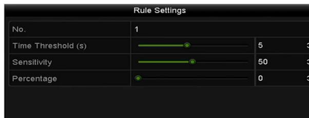
Figura 10–7 Establecer las reglas de detección de intrusión
