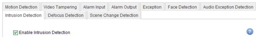
Figura 6–13 Configuración de la detección de intrusión en la cámara IP
