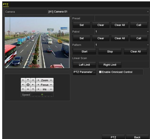
Figura 4–1 Configuración PTZ
