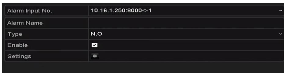
Figura 8–6 Interfaz de ajustes de entrada de alarma
