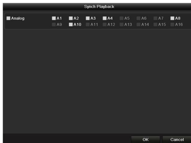
Figura 6–7 Selección de canales para la reproducción sincronizada.
