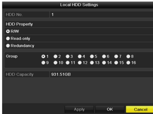
Figura 14–15 Configuración de la propiedad de la unidad de disco duro
