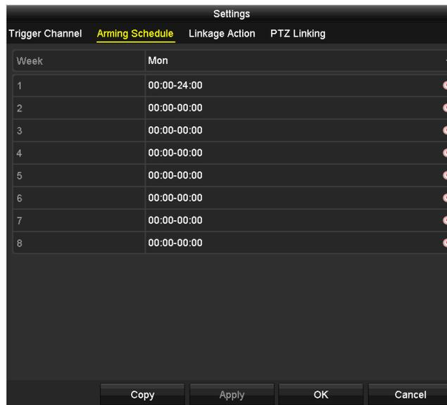
Figura 8–7 Establecer la programación de la entrada de alarma
