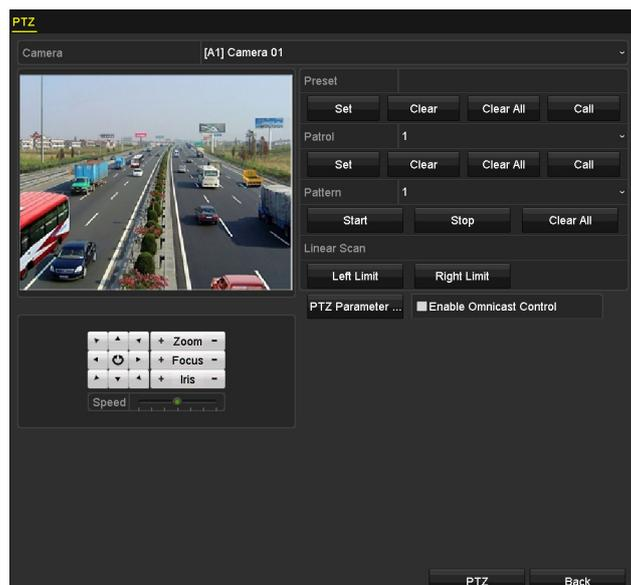
Figura 4–11 Configuración PTZ
