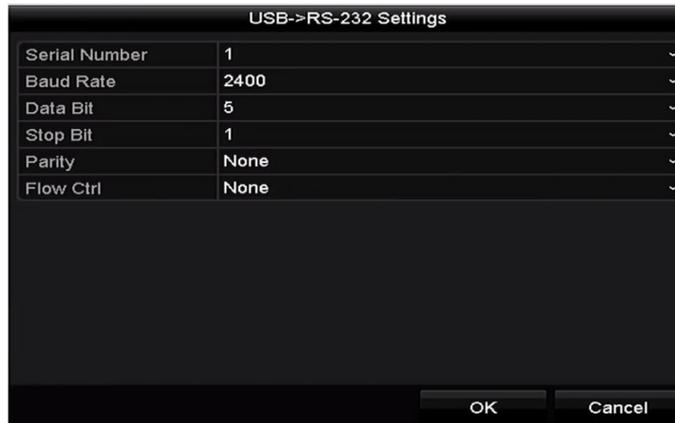
Figura 9–8 Configuraciones de la conexión USB a RS-232
